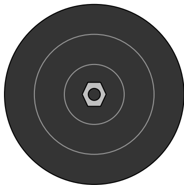
Gleichstromlichtmaschine (Zylindrische Form, Gehäuse ist bei Draufsicht von Riemenscheibe verdeckt, Stromstärke max. 38 A )
